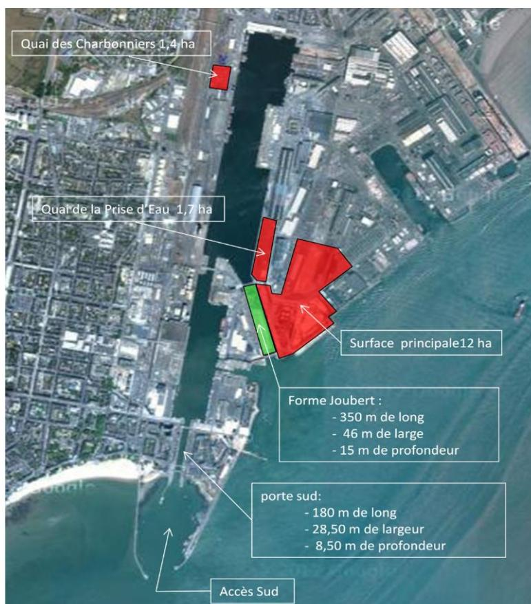
**Figure 1 : Implantation de la base logistique sur le port de Saint-Nazaire (source EMF).**
