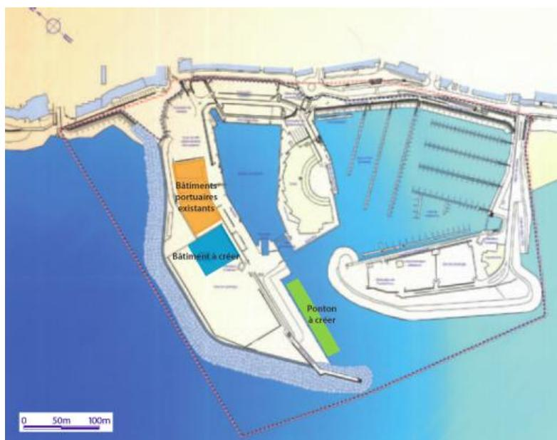
Figure 2 : Implantation indicative des infrastructures de maintenance à la Turballe (source SAEML LAPP).
